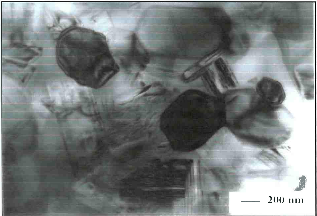
Figura 1. Microscopia eletrônica de transmissão de uma microestrutura geral de uma amostra de porcelana de ossos [5]
